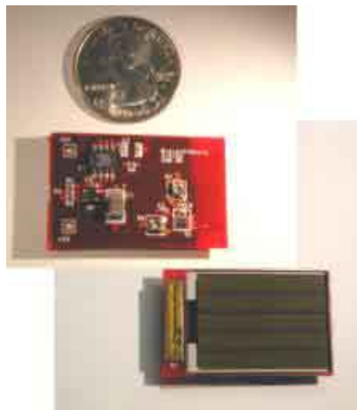
Figure 8 - Développé par le BWRC, le premier émetteur sans fil intégré et auto-alimenté par une cellule solaire (PicoBeacon).
