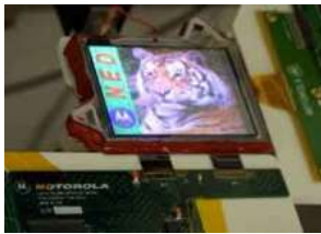
Figure 3 - Ecran NED par Motorola qui utilise les nanotubes comme source d'électrons.
