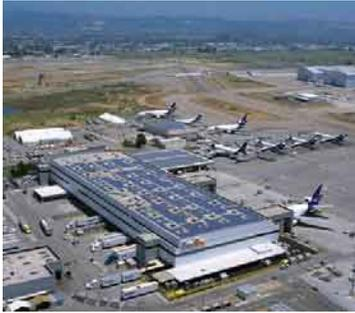
Figure 8. Vue aérienne des 900KW de capacité PV installés sur le toit de la plate-forme logistique de FedEx à Oakland (CA).
