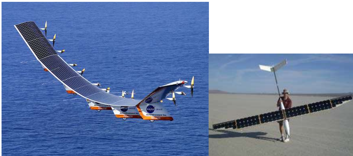
Figure 18 Gauche : Drone solaire 'Pathfinder' (fabriqué par Monrovia, CA, sur demande de la NASA) alimenté uniquement par des cellules solaires Sunpower, qui battit le record d'altitude de 15,000m en 1995. Envergure : 30m, masse de l'engin : 250kg. Crédits : NASA.
